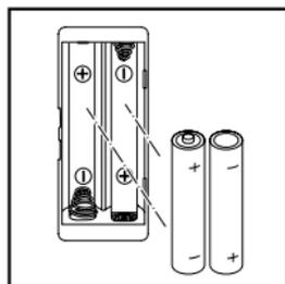
Bei Netzausfall wird das Gerät über Batterien versorgt. Setzen Sie zwei AAA-Batterien ein. Die Uhrzeit wird in diesem Fall gehalten, jedoch nicht angezeigt.
